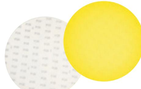
Fein gelochte Klettscheibe für Eintellerschleifmaschine. Für den Feinschliff von Holzböden. Durch die flächendeckende, feine Perforation setzt der Schleifstaub nicht die Körnung zu. Das erhöht die Standzeit und verbessert das Schliffbild. Durchmesser 406 mm. Silizium-Karbid Korn auf Vliesunterlage.
