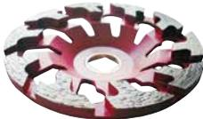
Für weiche, abrasive Materialien wie Estrich und Spachtelmasse. Gute Abtragsleistung durch grobe Diamanten, hohe Standzeit durch harte Bindung.
